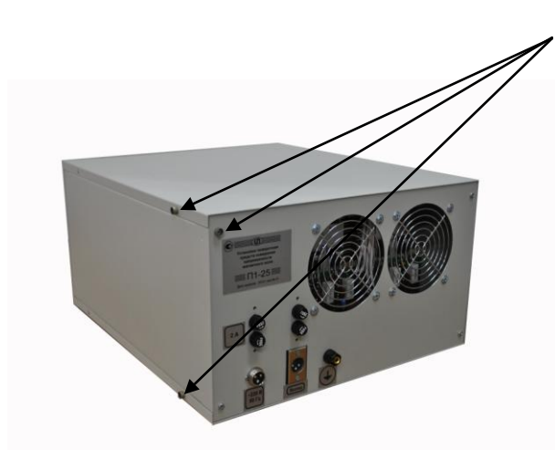
Рисунок 13. Места пломбирования. 1 – место пломбирования УГПТ
