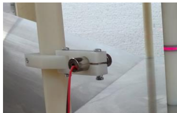
Рисунок 9.1 Крепление лазерного указателя на стойке ПС
