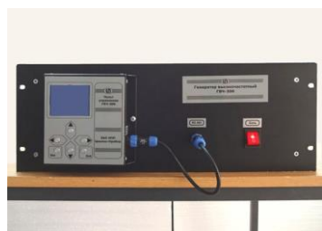
Рисунок 6.2 Передняя панель ГВЧ с закрепленным на ней ПУ
