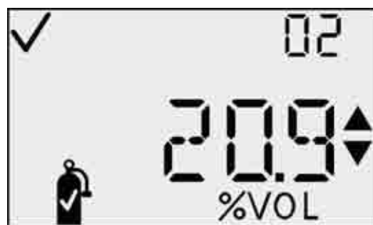
Экраны установки значения концентрации поверочного газа в PPM и % от объема
