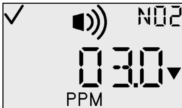
Экран настройки нижнего порогового значения срабатывания аварийной сигнализации
