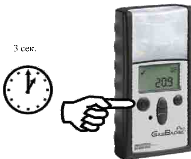
Включение персонального газоанализатора GasBadge Pro
