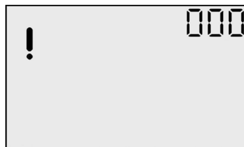
Экран «отсутствия чувствительного элемента»
