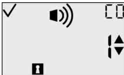
Установка блокировки аварийного сигнала
