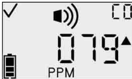
Экран верхнего порогового значения срабатывания аварийной сигнализации (High Alarm)
