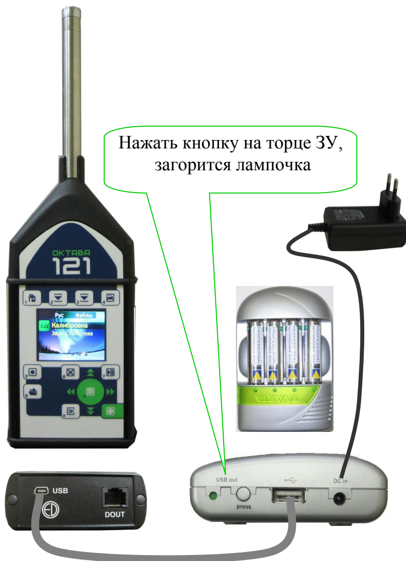
Схема 3. Подключение прибора к внешнему источнику питания
